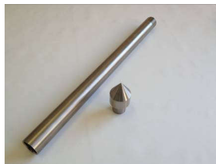
Asta di spinta e punta conica in acciaio INOX.
