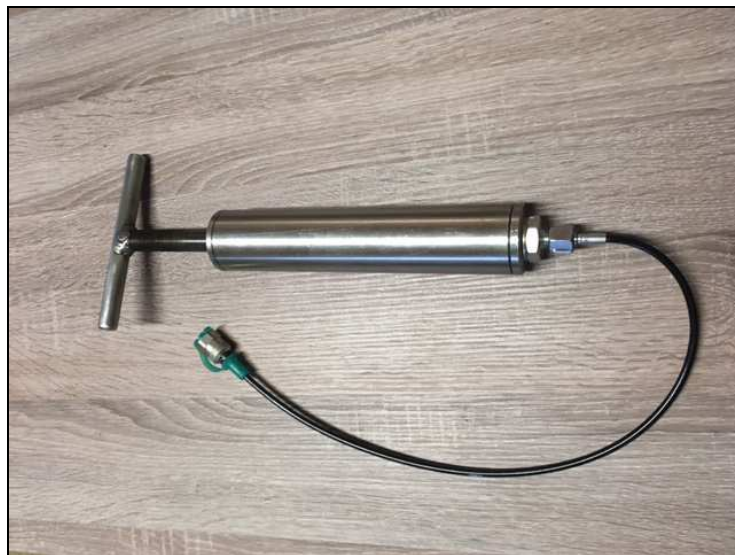
Figura 3 Pompa di ripressurizzazione
