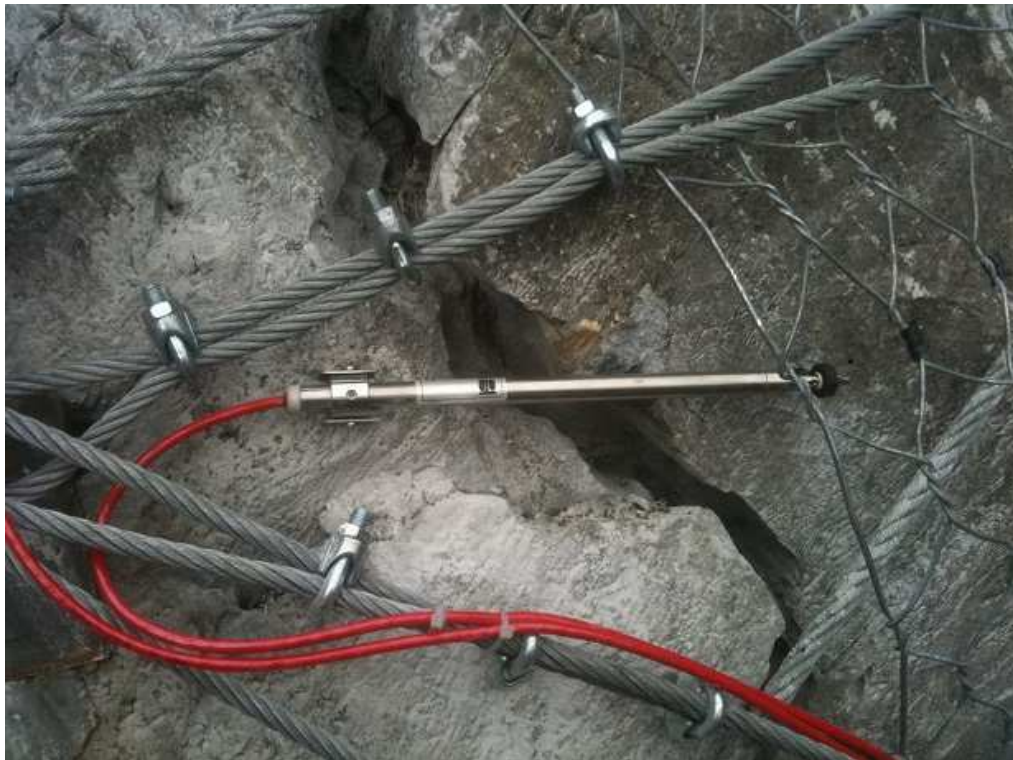
Fig. 3 – Fessurimetro elettrico – Esempio di installazione a parete
