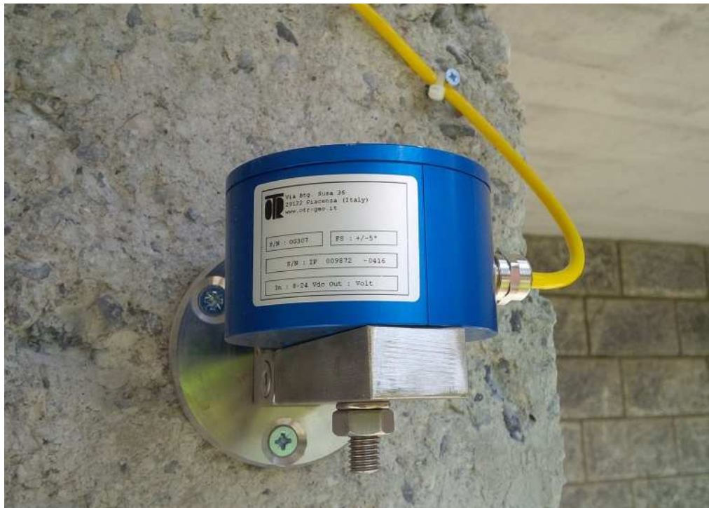
Fig. 3 – Inclinatorio elettrico da parete – Esempio di installazione a parete
