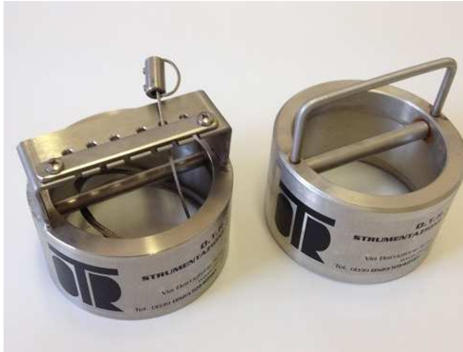
Fig. 3 – Teste di sospensione per estensoinclinometri fissi
